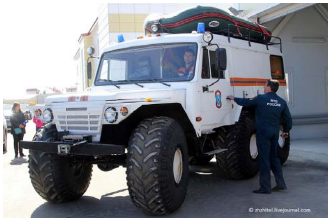
Рис. 4. Колесный вездеход на шинах низкого давления ТТМ 3930АСМ [10]
